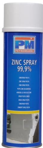
**PM ZINKSPRAY** is een snel drogende spray voor het koudverzinken en galvaniseren van metalen oppervlaktes. De coating is geleidend en geschikt voor puntlassen. PM ZINKSPRAY is een ideale grondering voor opvolgende laklagen. Bevat 99,9 % zink en heeft een temperatuurbereik tot 600°C.
