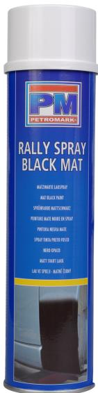
**PM MATZWARTE LAKSPRAY** wordt gebruikt om kleine lakschades aan de carrosserie te herstellen. Ook kunststofdelen laten zich na gebruik van een kunststofprimer in de carrosseriekleur sputten. Blank metaal eerst me een primer behandelen. Oppervlak grondig schoonmaken, roest verwijderen en opschuren. Bus 2 minuten goed schudden. Spuit een klein proefstrookje voor kleurcontrole. Sputtafstand 25 cm. Stofdroog na 20 minuten volledig droog na 12 uur.
